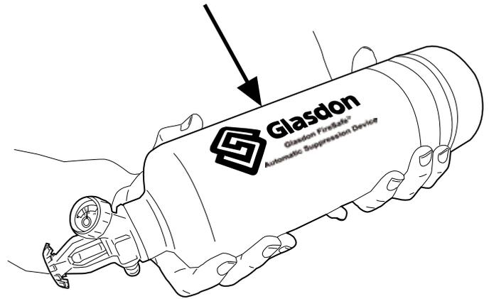
Inspección visual de que el dispositivo no está dañado. En caso de signos de corrosión externa, la unidad completa debe ser sustituida.
