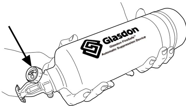
FireSafe de Glasdon es un dispositivo complementario que en ningún caso debe sustituir a otros sistemas de extinción. La inspección periódica y la reposición inmediata en caso de daños o descarga es imprescindible para un funcionamiento adecuado.
