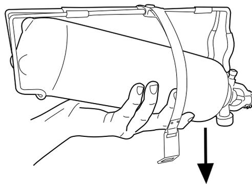
2. Desmonte el dispositivo y proceda con la botella usada como corresponde al tipo de residuo del que se trata. Recomendamos que se recicle como residuo metálico.
