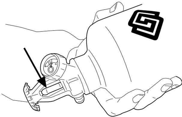
Inspección visual de la ampolla de cristal. Debe permanecer intacta. En caso de que el dispositivo hubiera sido activado, la ampolla no se encontrará en su posición y la unidad completa debe ser sustituida.
