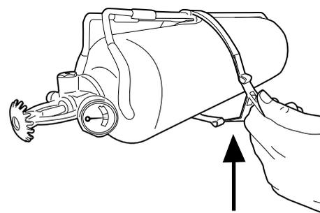
3. Rodéelo con la abrazadera ya instalada y asegure el cierre.
